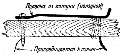
Рис. 14 Устройство переключателя
