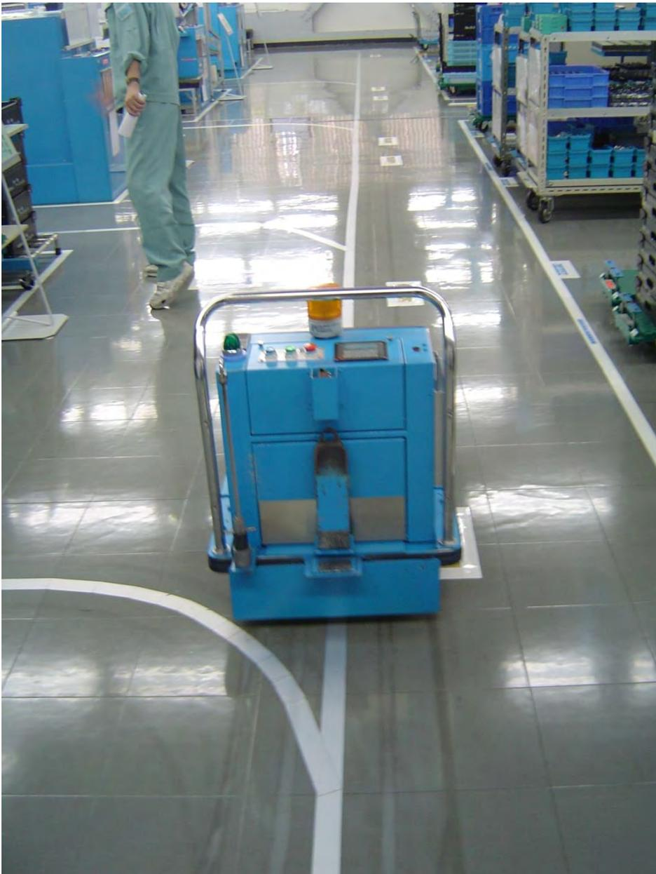
Робот-тележка для подвоза компонентов к нужному месту конвейера. Обратите внимание на белую линию на полу – ее и читает робот для определения маршрута.
